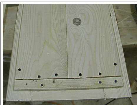
Les planches de remplissage du cadre sont plaquées au dos de la porte
