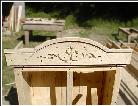
Le raccord de gauche entre la partie droite et la courbe sera un peu arrondi.
