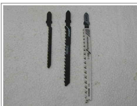
Les courbes serrées se découpent à l'aide de la lame de gauche.
